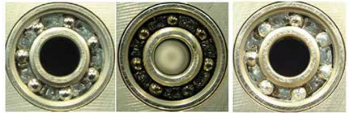
Figura 2. Cambios en la grasa de los rodamientos después de quinientas horas de operación a diferentes voltajes. De izquierda a derecha: 1.2 V ; 1.3 V ; Sin voltaje
